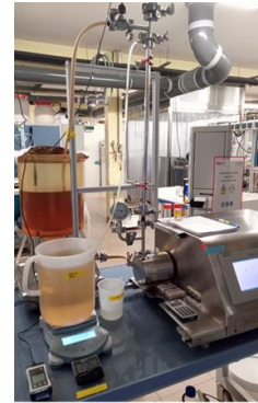
Pilote de filtration Cogent (MFT)
